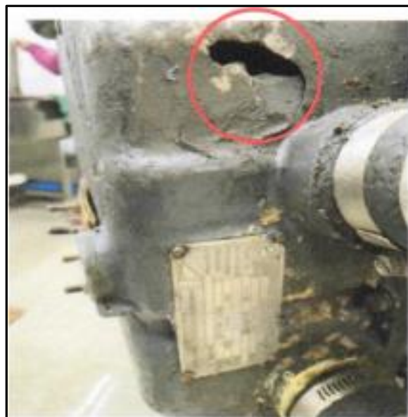
Fotografía No. 5: Inspección al motor. Cáster de aceite con orificio por impacto.
