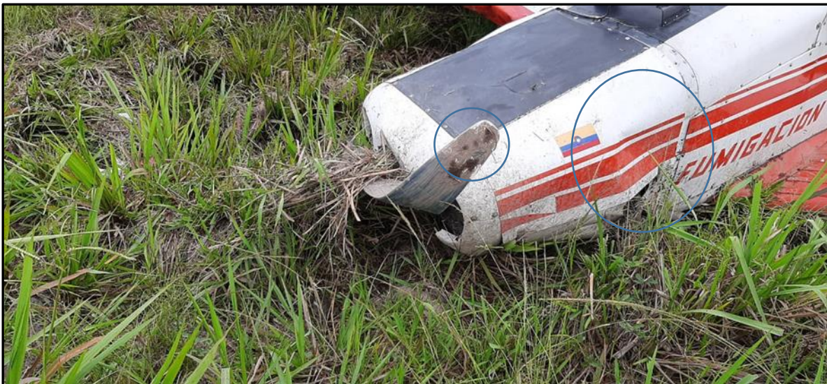
Fotografía No. 3: Deformación de hélices y motor
